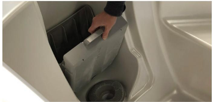
**Étape 4 :** Retirez et remplacez le filtre. Pour retirer le filtre Simplicity, compressez les plis et poussez vers l'avant. Soulevez le bord du filtre au-delà de la languette de capture. Cela vous permettra de soulever le filtre usagé du porte-filtre. Jetez le filtre usagé.
